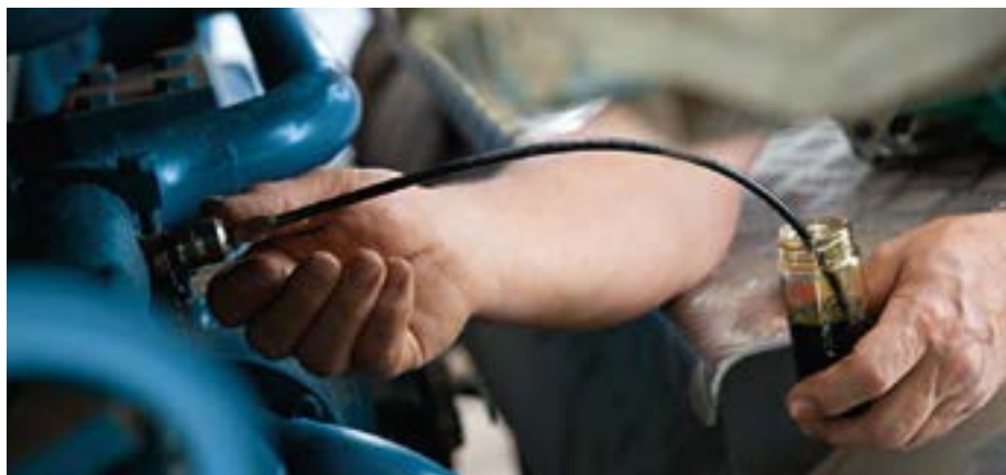
Eine regelmäßige Probenentnahme und Kontrolle des Gasmotorenöls, wie auf dem Foto gezeigt, reicht nicht aus. Tectrol rät grundsätzlich zu Analysen des Kühlmittels nach maximal 2.000 Betriebsstunden.
