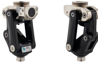
Bei der im Cheetah® Knee verbauten Mikrohydraulik lässt sich der Grad der Dämpfung in Beuge- und in Streckrichtung separat über Ventile an der Außenseite des Kniegelenks regulieren. Damit die lineare Kolbenbewegung in eine Drehbewegung umgesetzt werden kann, befindet sich im Hydraulikraum eine Zahnstange in Kombination mit einem Zahnsegment.
