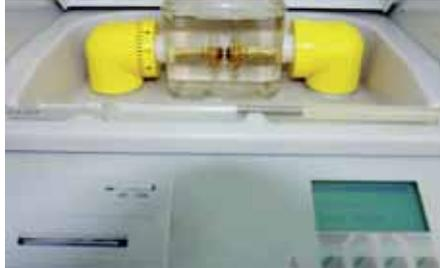
*Funkenentladung zwischen den Elektroden in der ölgefüllten Prüftasse*
