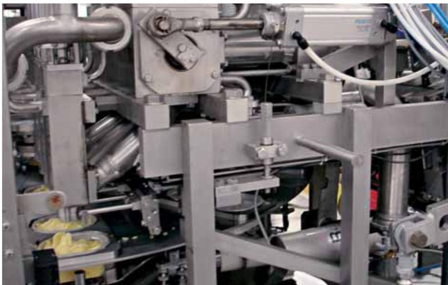
Genau portioniert – die Dosierung der Feinkostsalate wird mit Druckluft gesteuert und angetrieben
