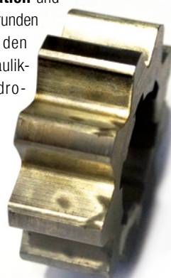
Kavitationsschäden an einer hydraulischen Zahnradpumpe
