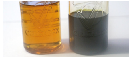
links: frisches Hydrauliköl, rechts: nach „Dieseleffekt“
