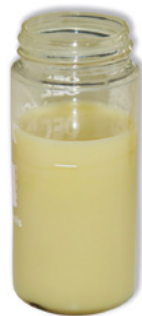
Hydrauliköl mit emulgiertem Wasser
