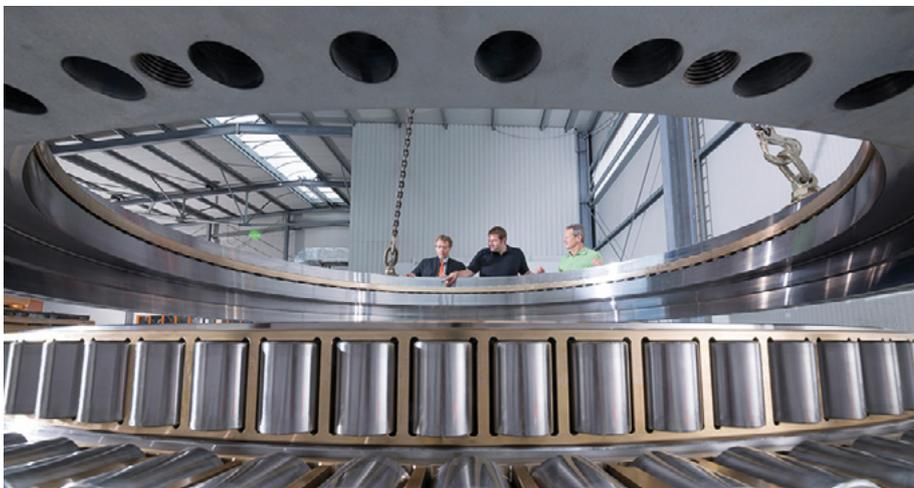
Höchste Präzision in beeindruckender Dimension – dreireihiges IMO Hauptlager für eine 5 MW Windkraftanlage
