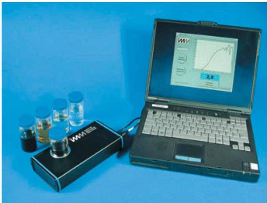
Außerdem wird der optische Eindruck der Probe von außen schriftlich, d.h. über einfaches Tippen auf entsprechende Bezeichnungen oder Symbole auf einem „Touchscreen“, festgehalten. Sind Schlieren im Öl? Ist die Probe trübe? Gibt es 2 Phasen? Hat sich Wasser separiert? Ist Bodensatz vorhanden?
