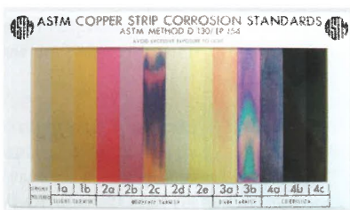
Vergleichsskala für Kupfer-Korrosion
