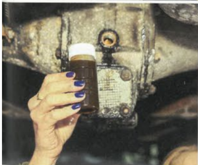
Die Probenentnahme an Getriebe und Differential ist mitunter etwas schwierig, selbst wenn wie hier eine Hebebühne zur Verfügung steht. Die Ablassschrauben sind selbst bei ansonsten gut gewarteten Liebhaberfahrzeugen oft jahrelang nicht geöffnet worden
