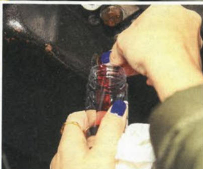
Die Probenentnahme an Getriebe und Differential ist mitunter etwas schwierig, selbst wenn wie hier eine Hebebühne zur Verfügung steht. Die Ablassschrauben sind selbst bei ansonsten gut gewarteten Liebhaberfahrzeugen oft jahrelang nicht geöffnet worden
