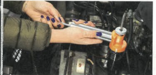
Mit dem Werkzeug lässt sich die Probe über das Führungsrohr des Ölmesstabs nehmen. Besser ist jedoch das Ablassen
