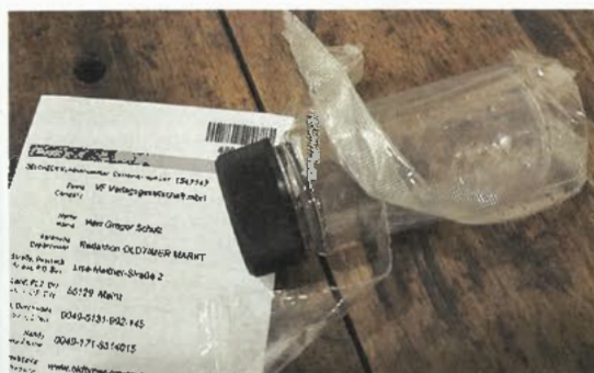
Das Testset von Oilcheck erhält neben einigen Unterlagen und der Vorgangsnummer ein Kunststoffgefäß für die Ölprobe
