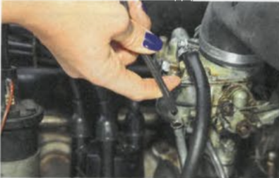
Je nach Durchmesser des Rohrs muss der passende Schlauch verwendet werden
