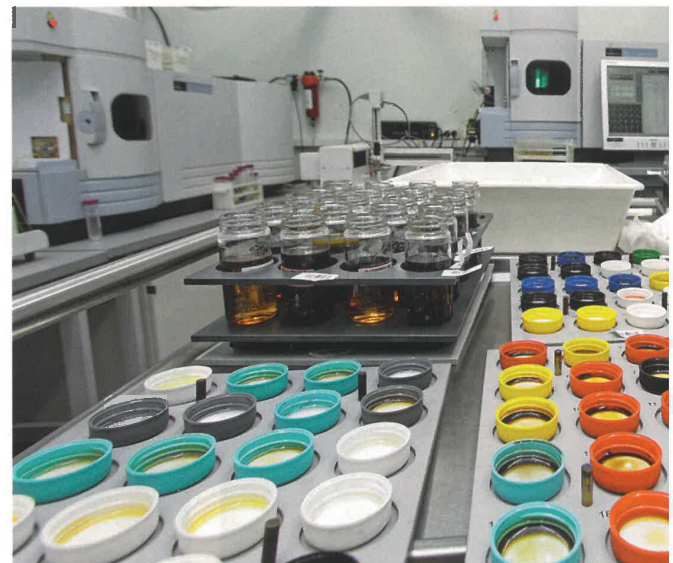
Elementanalyse: Das grüne Leuchten im Gerät (Mitte) ist der Plasmastrom,
