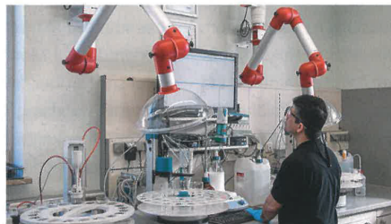
Der Säuregehalt wird mittels Titration bestimmt.
